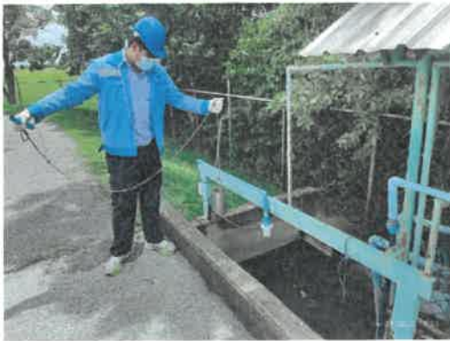
Collecting Tank, Polishing Pond ระบบบำบัดน้ำเสียแห่งที่ 5 ภาพที่ 3.5.7-2 (ต่อ) การเก็บตัวอย่างน้ำทิ้งระบบบำบัดน้ำเสีย
