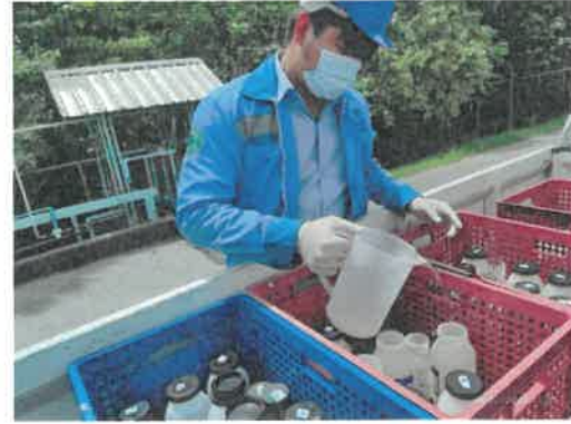
Collecting Tank, Polishing Pond ระบบบำบัดน้ำเสียแห่งที่ 5 ภาพที่ 3.5.7-2 (ต่อ) การเก็บตัวอย่างน้ำทิ้งระบบบำบัดน้ำเสีย
